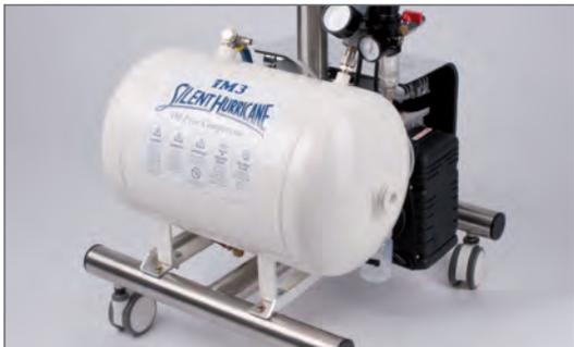
iM3 hat den ersten ölfreien Kompressor für Dentaleinheiten mit Absaugsystem entwickelt. Die ölfreie Technologie beseitigt das Risiko von Ölkontamination in der Luftzufuhr der Dentaleinheit. Sie reduziert zudem deutlich den Wartungsaufwand. Die Kompressorstellfläche beträgt 51 x 53 cm. Der ölfreie Motor erzeugt weniger Wärme und arbeitet daher zuverlässiger als ein herkömmlicher Kompressor mit Öl.
