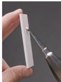
Das Bild zeigt den Winkel des Instruments zum Schleifstein.
