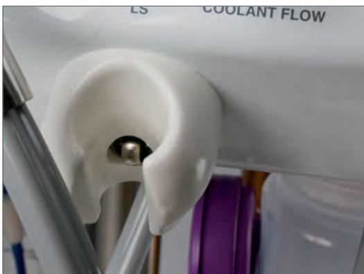
Nicht alle automatischen Schalter an Handstücken sind gleich! iM3 hat einen pneumatischen Schalter ohne elektrische Komponenten entwickelt. Dank des Schalters muss das jeweilige hochtourige oder niedertourige Handstück nicht mehr manuell aktiviert werden. Falls es jemals notwendig wird, kann der Anwender den Schalter bei Bedarf in Sekundenschnelle selbst auswechseln, sodass er sich über einen nötigen Schalteraustausch keine Gedanken machen muss.
